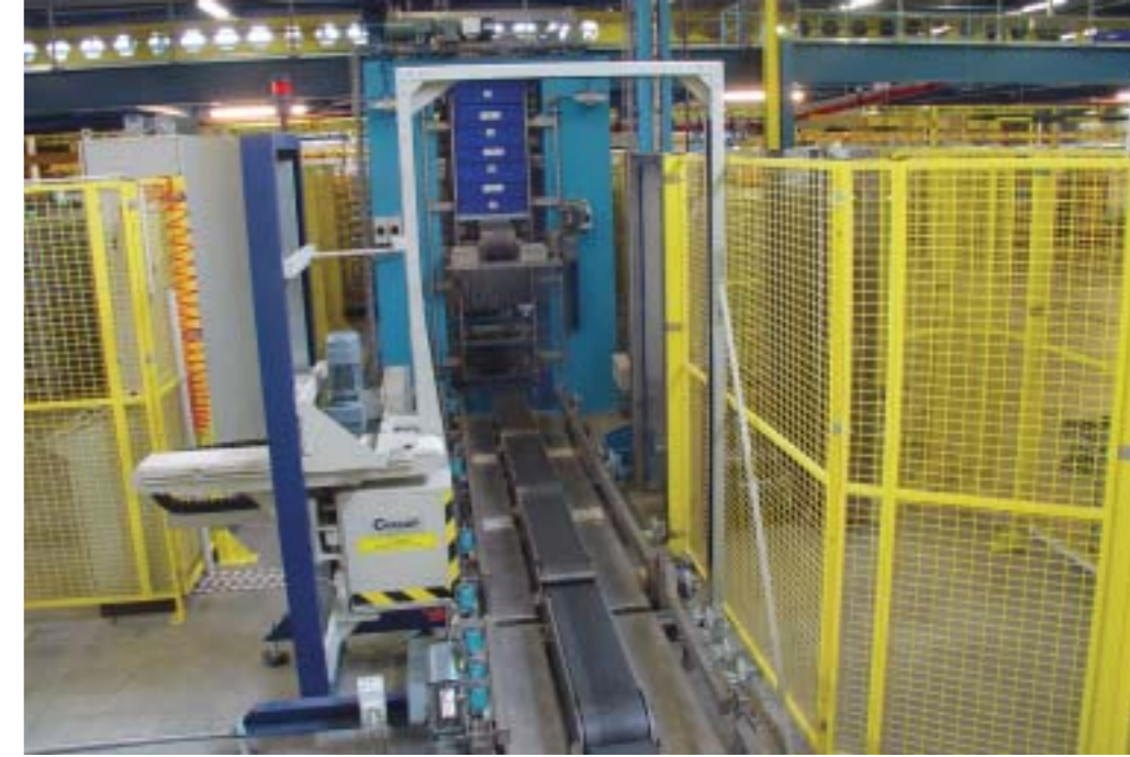
Drie robots stapelen de filiaalkratten per winkel op een dolly, de deksel en een polyester omsnoeringsband maken er een stabiele zending van
