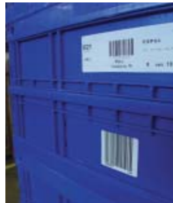
Het kratetiket bevat het routenummer, de filiaalcode, een dolly-volnummer en een verwijzing naar de artikelgroep
