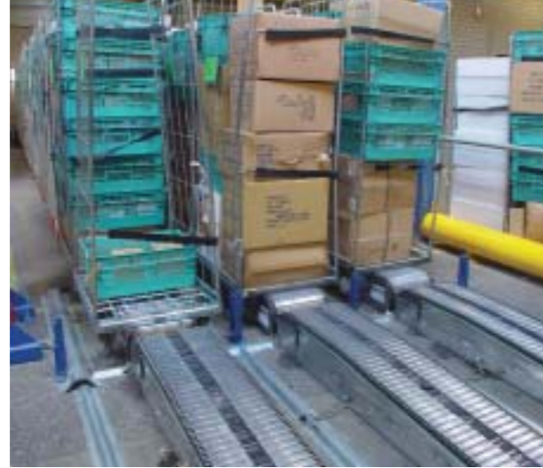
Na scanning van het artikel en de krat weet het DPS exact het aantal artikelen en het gewicht van de boxinhoud
