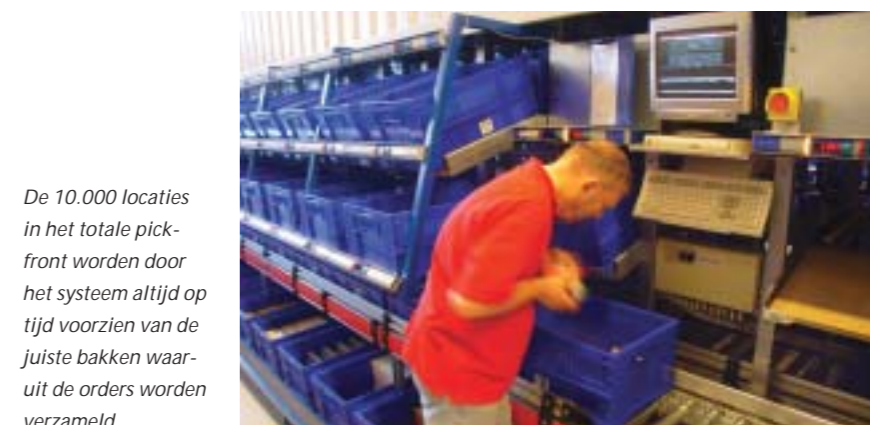
Het DPS kan in totaal 100.000 bakken herbergen; in elf gangen werken twintig kranen aan de optimale verdeling over de pickzones
