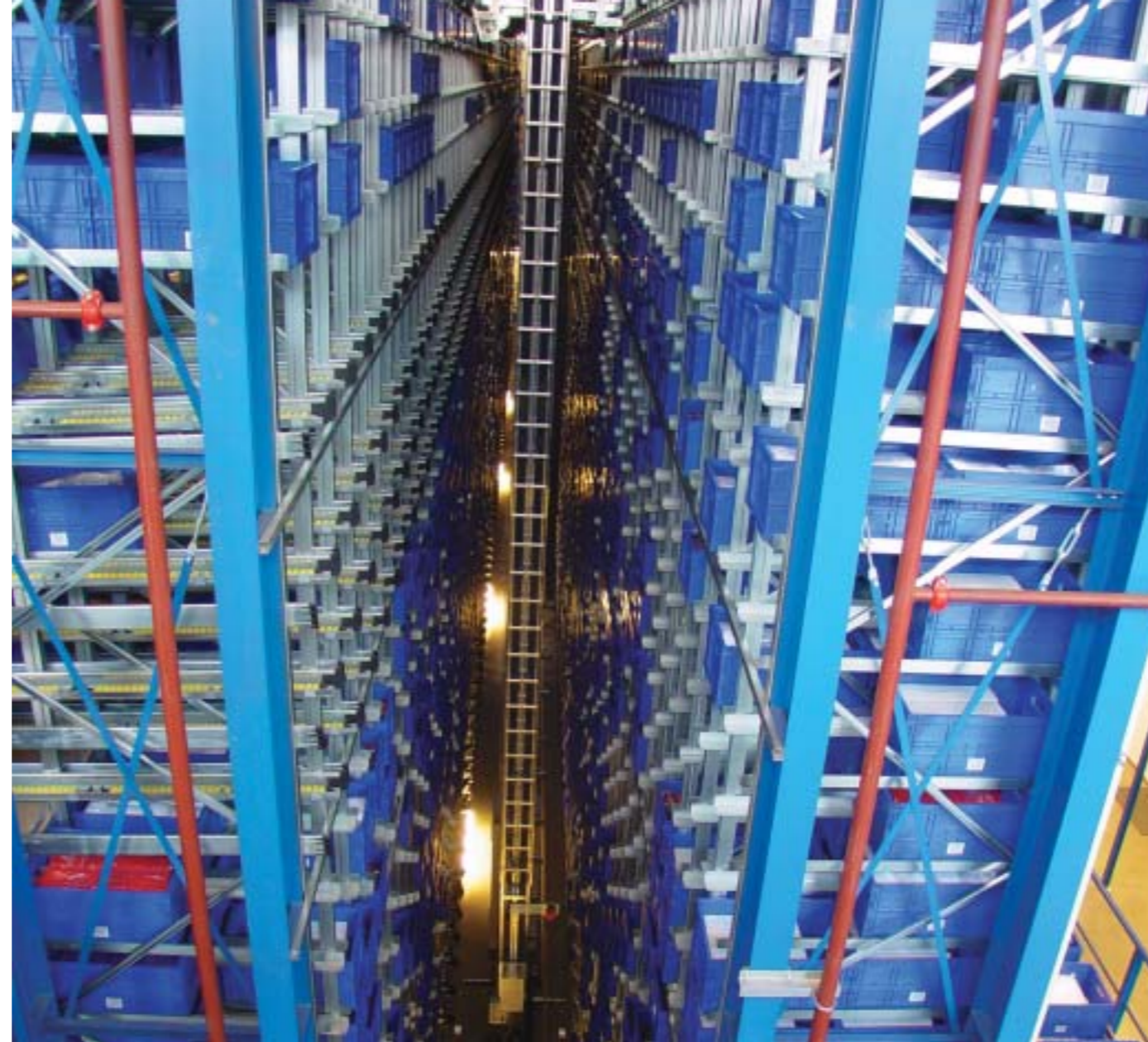
De 10.000 locaties in het totale pickfront worden door het systeem altijd op tijd voorzien van de juiste bakken waaruit de orders worden verzameld
