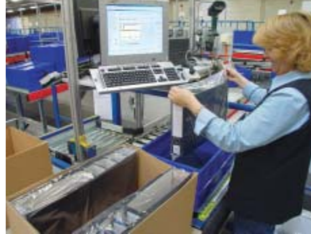
Na scanning van het artikel en de krat weet het DPS exact het aantal artikelen en het gewicht van de boxinhoud
