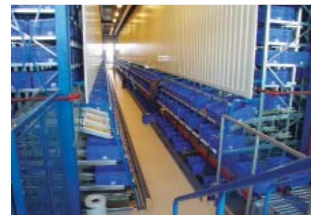
Het indrukwekkende DPS telt 70 verzamelstations verdeeld over tien gangen en twee verdiepingen
