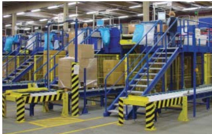
Ruim 14.000 artikelen zijn geschikt voor het DPS en moeten eerst omgepakt worden in blauwe klappakkratten; het ompakstation telt zestien dubbel uitgevoerde werkplekken
